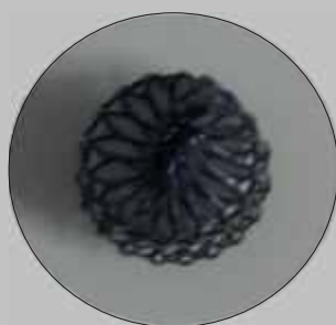
CN 25 Abschnitt, einseitig verschweißt, Ansicht oben
