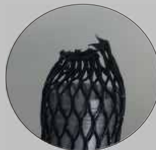
CN 25 Abschnitt, einseitig verschweißt, Ansicht Seite
